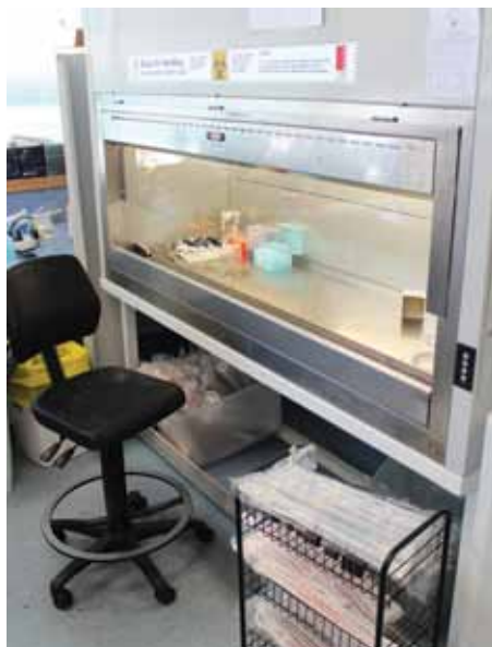
Komora sterylizująca II klasy w jednym z laboratoriów SymbioticA na Uniwersytecie Zachodniej Australii, fot. dzięki uprzejmości artysty / Class 2 Sterile Hood at one of SymbioticaAs labs at the University of Western Australia, photo courtesy of the artist
