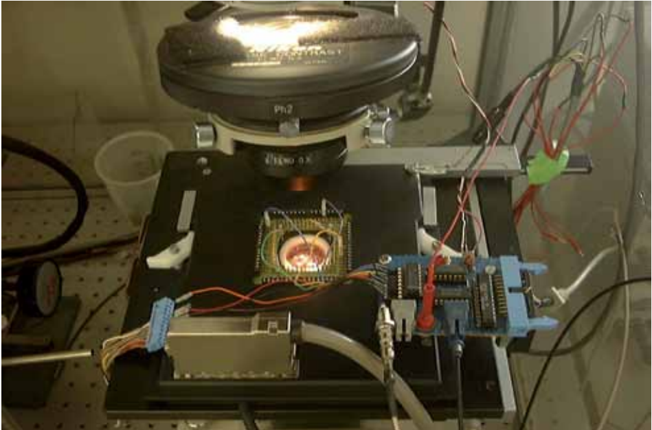
| System elektrofizjologiczny: szalka z matrycą wieloelektrodową (MEA) podłączona do wzmacniacza umieszczonego pod mikroskopem umożliwiającym obrazowanie / An electrophysiology system: a Multi Electrode Array dish connected to an amplifier placed under a microscope for imaging, fot. / photo Dr Steve Potter
