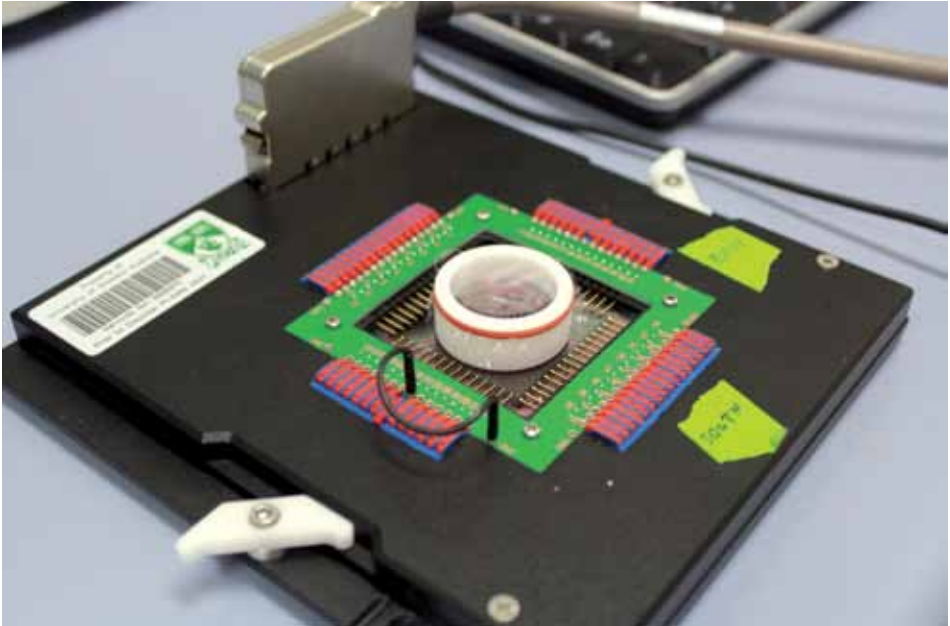
| Szalka MEA we wzmacniaczu sygnału w laboratorium Ben-Ary'ego, fot. dzięki uprzejmości artysty / MEA dish in the signal amplifier at Ben-Ary's Lab, photo courtesy of the artist
